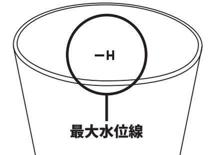
※バケツに水を入れる際は、駆動部からバケツを外し、「バケツ部単体」で入れて下さい。駆動部に水がかかると、故障の原因になります。
